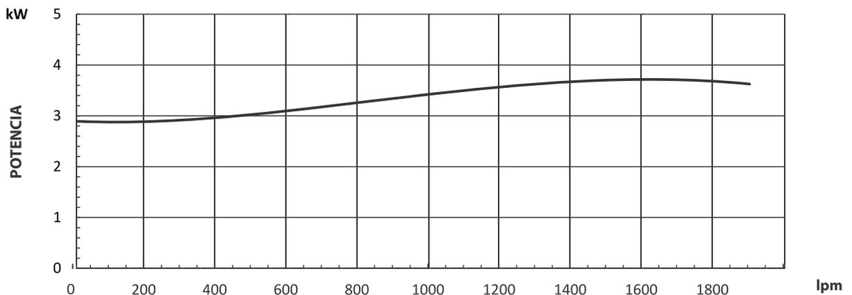
Prueba realizada con agua, gravedad específica 1.0 @ 20 °C (68 °F); otros líquidos pueden variar el rendimiento.
