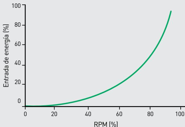
Este gráfico muestra el enorme aumento en el consumo de energía a medida que aumenta la velocidad de la bomba. Al reducir la velocidad de la bomba se reducen marcadamente los costos energéticos.
